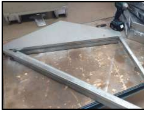
STEP 38: Attach lid end to lid RHS end.
